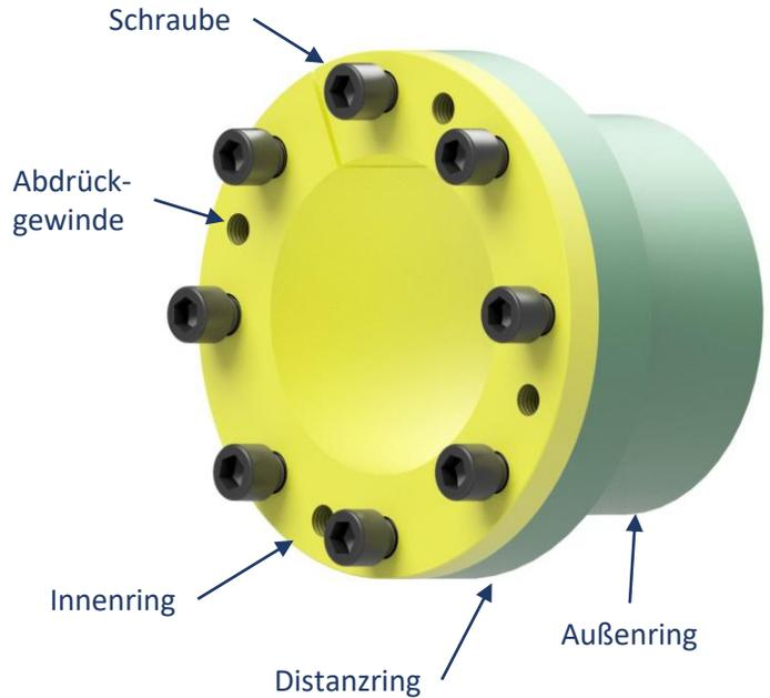
2. Welle und Nabe leicht ölen und Spannsatz in den Einbauraum schieben.
