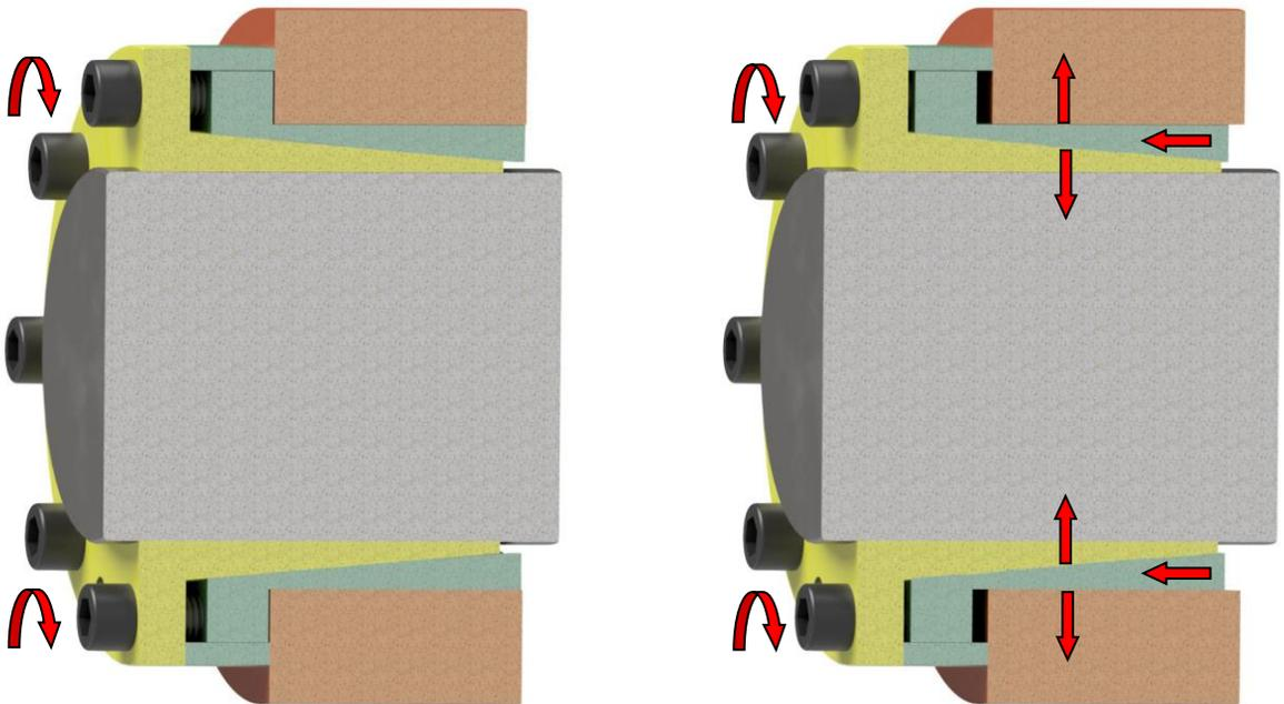
Der Spannsatz ist wartungsfrei und die Schrauben müssen nicht nach einer bestimmten Betriebszeit nachgezogen werden.
